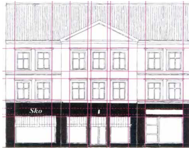
Forretningsfacaderne skal tilpasses husets lodrette og vandrette linier, så der skabes god balance i bygningens samlede udtryk.
